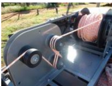
Sistema de tracionamento dos cabos
