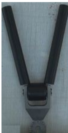
Dispositivo em V para auxílio de passagem dos cabos
