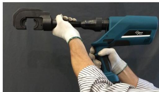
Conexão de prensa terminais
